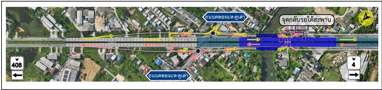
รูปที่ 6-4 แยกคลองแห รูปแบบที่ 3 สะพานยกระดับ (Flyover) ร่วมกับจุดกลับรถได้สะพานและวงเวียนขนาดเล็ก
